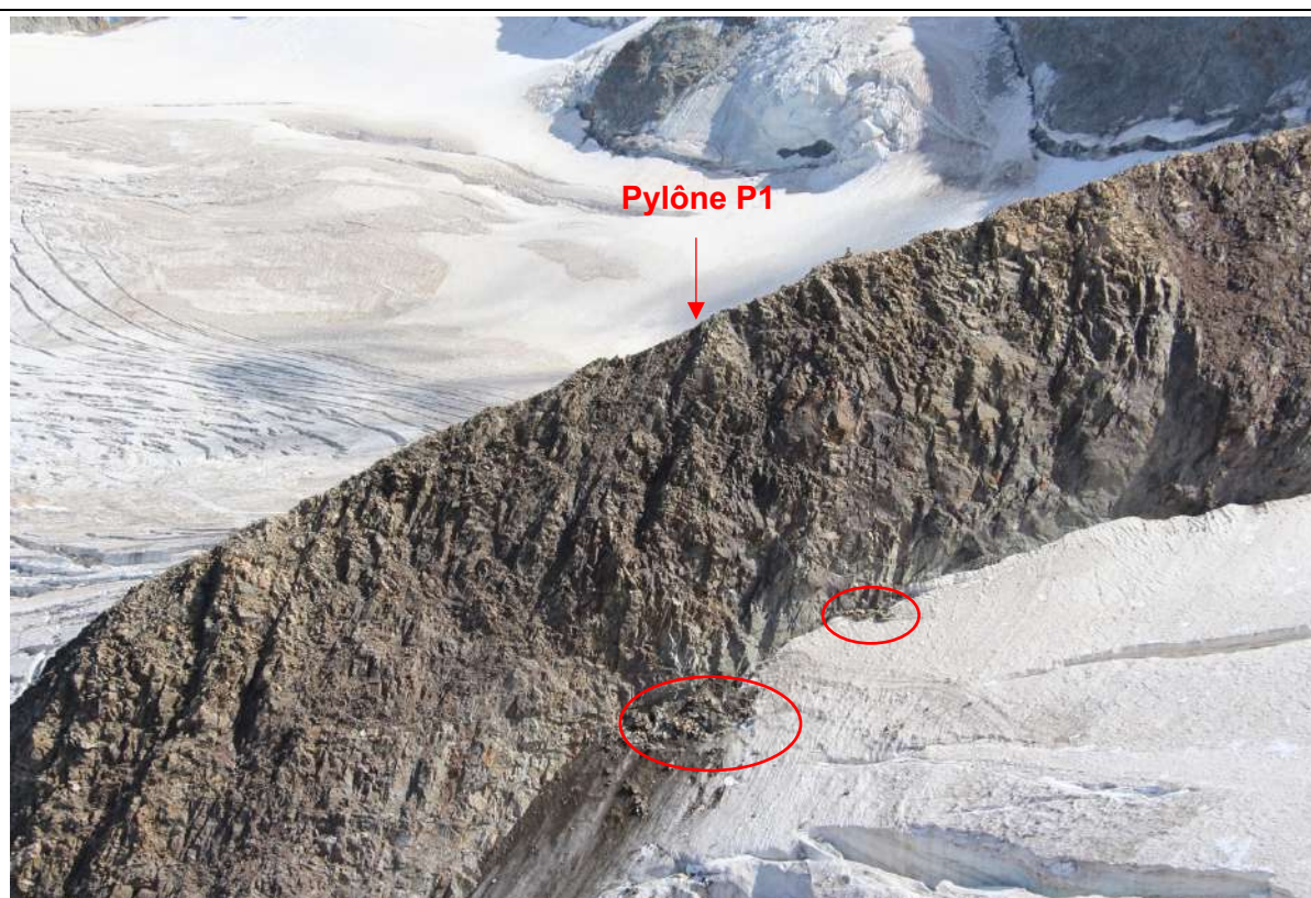
Figure 3 : Vue de la face Ouest de l'éperon du pylône P1. On observe bien la partie inférieure de falaise de teinte plus claire, qui correspond aux zones récemment déglacées par le retrait glaciaire. Les éboulements principaux se produisent dans ces zones.
